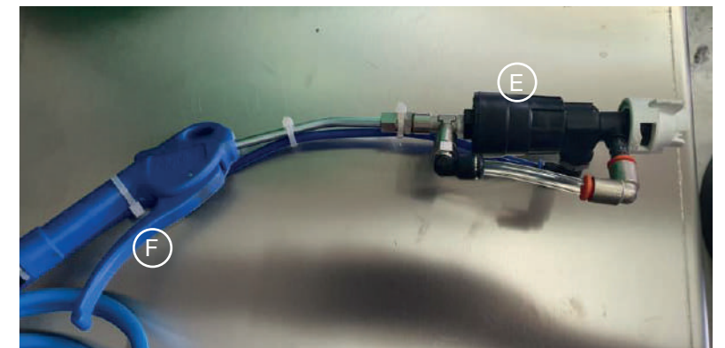
E. Ugello Fog della pistola irroratrice F. Leva della pistola irrogatrice
